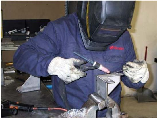
Figura 4 – Saldatura tipo TIG
