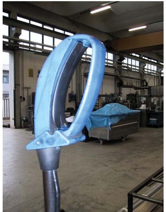
Figura 3 – Interruttore a pressione continua posto sull'impugnatura
