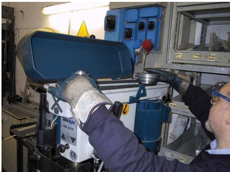
Figura 3 – Cambio della velocità di rotazione del mandrino
