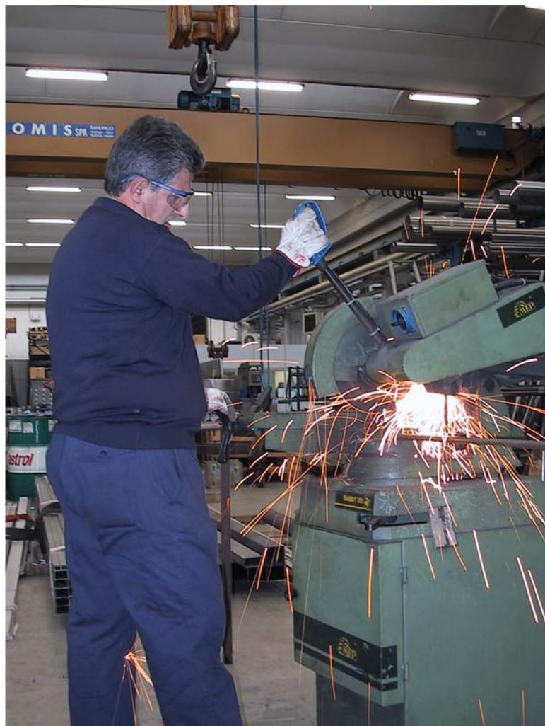
Figura 4 – Operazione di troncatura
