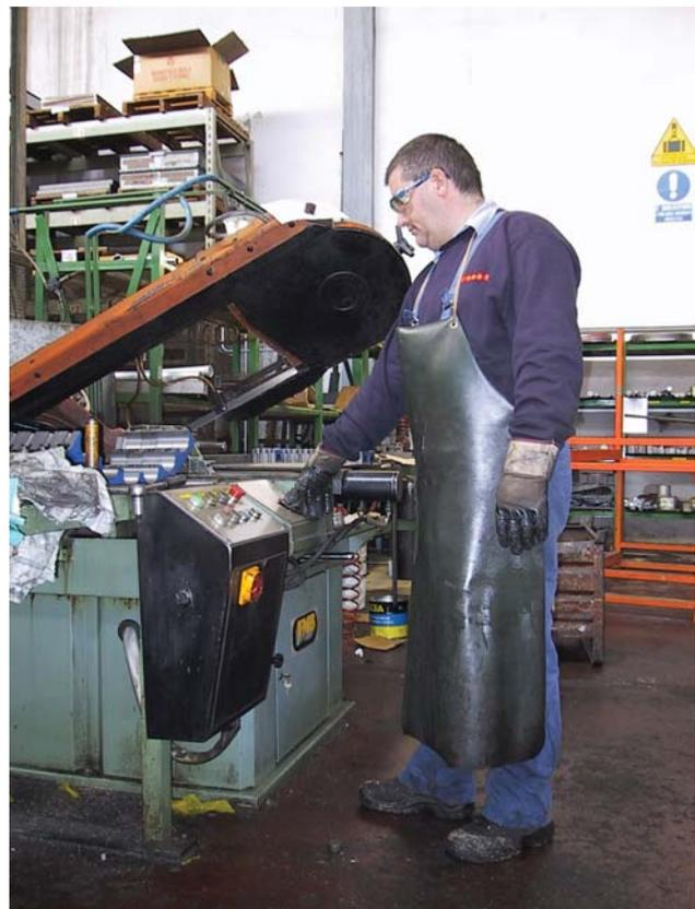
Figura 4 – Operazione di taglio con il pulsante di azionamento
