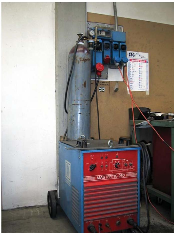
Figura 1 – Generatore e bombola di gas inerte
