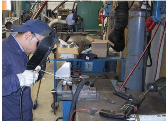
Figura 5 – Saldatura a elettrodo
